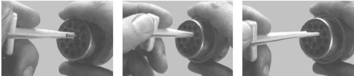
图 7-16. HD/HDP 触头拆卸
